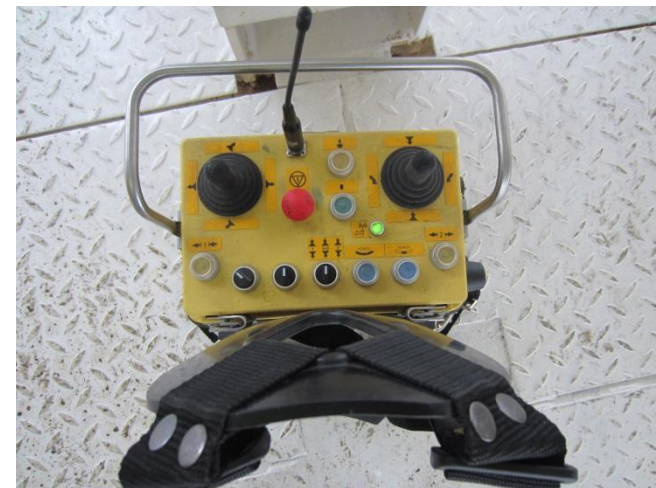
Radio Commande Grue a Voussoir
